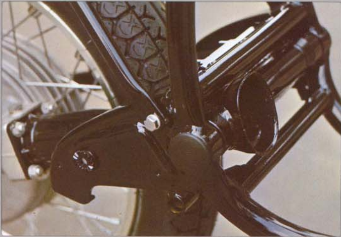
5 Op kegellagers scharnierende achtervork.
