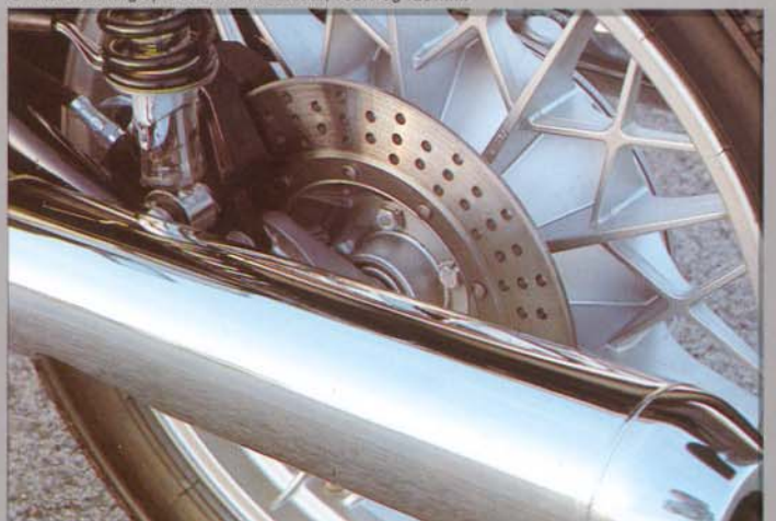
14 Hydraulisch bediende schijfrem van het lichtmetalen gietwiel achter.
