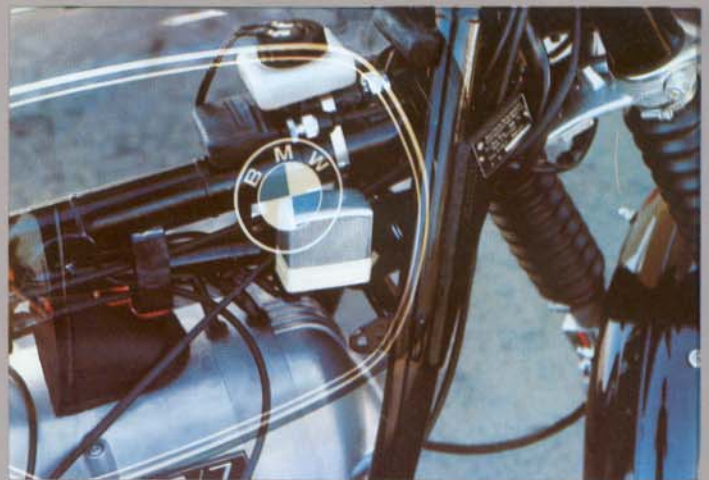
4 Hoofdcilinder beschermd onder de tank gemonteerd.
