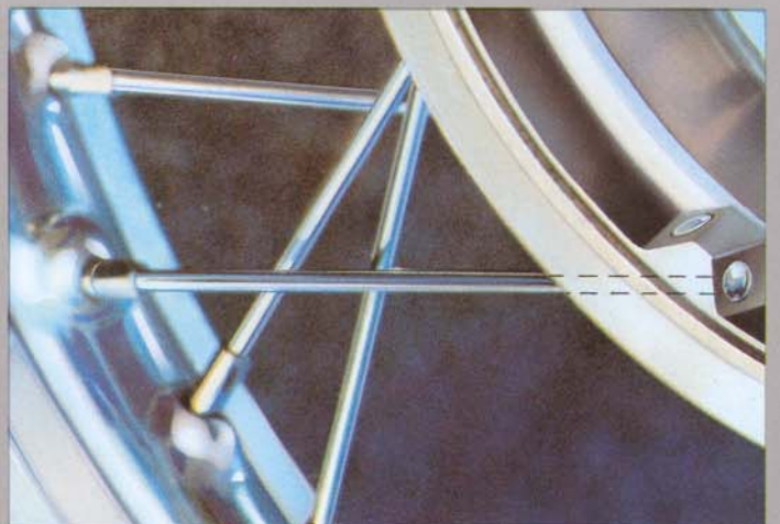
12 Verchroomde spaken, die recht in de naaf zijn gezet.
