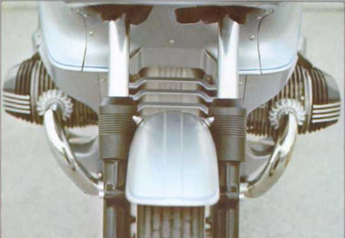
9 Op kegellagers draaiende telescoopvork, veerweg 200mm.
