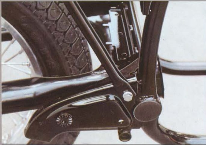
3 Tegen roest beschermd dubbel wiegframe.
